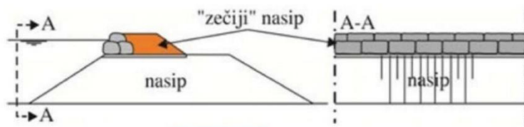
Слика бр. 3: Зечији насип од два реда врећа
