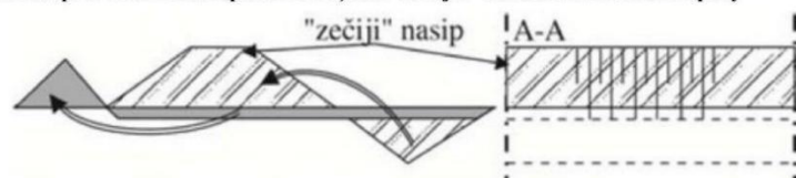
Слика бр. 8: Шематски приказ извођења “зечијег” насипа на високом терену
