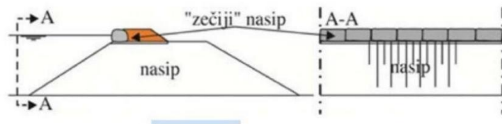
Слика бр. 2: Зечији насип од једног реда врећа
